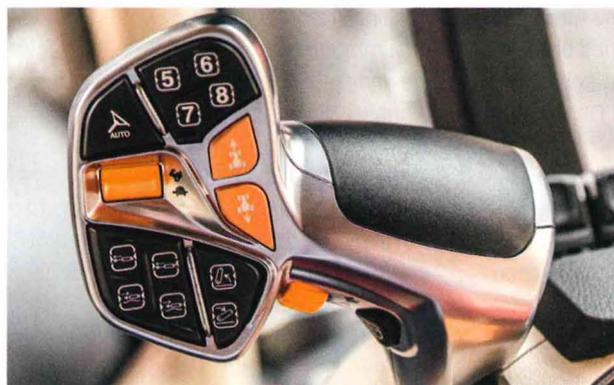
Der Fahrhebel ist in der Funktion gleich geblieben. Zusätzliche Funktionen erweitern die Möglichkeiten, wenngleich die gummierten Taster nicht alle blind zu unterscheiden sind.
