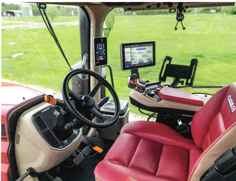
Platz satt: Mit der neuen Bedienarmlehne kann sich der Fahrer um bis zu 40° nach rechts drehen.
