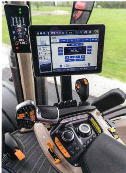
Das Hydraulikklavier ist mit farbigen LEDs markiert, die sich je nach Zuordnung ändern.
