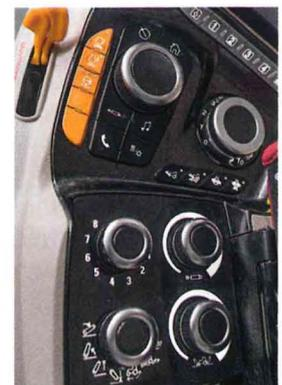
Unter der Armlehne gibt es neue Schnellzugriffe für EHR und Hydraulikventile.
